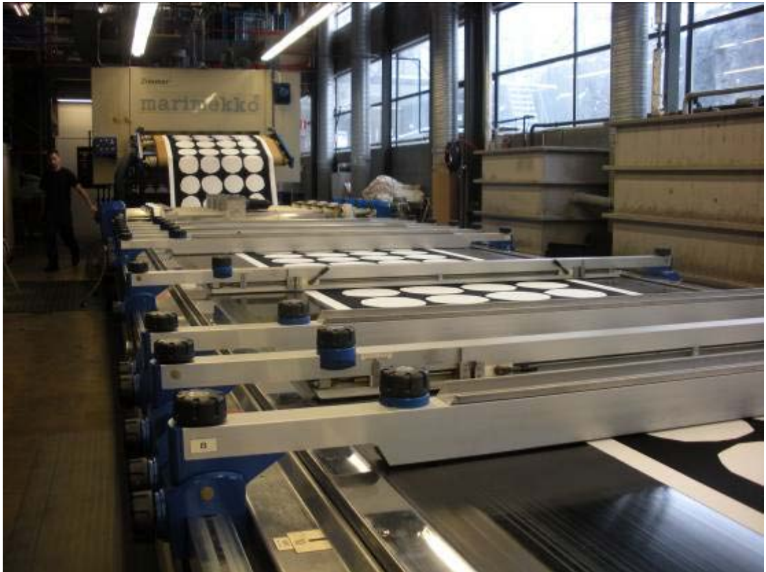
KUVA 3. Zimmer laaka/rotaatiopainokone. Valokuva P. Somersaari 2012
