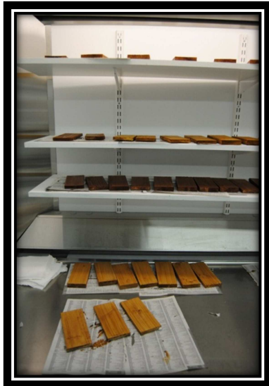
Kuvio 14. Kuultavat näytelevyt vetokaapissa.
