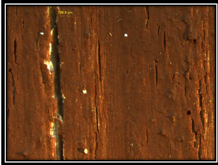
Kuvio 19. Koestettu levy sävynumero 1809 laitteessa WOM.
