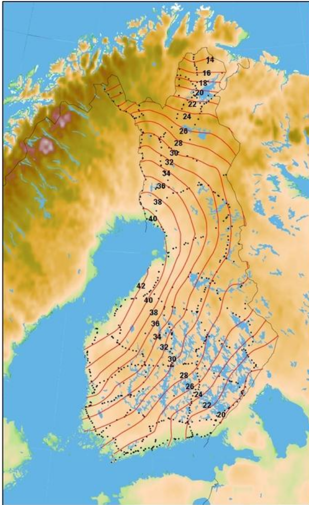
Kuva 23. Vaaituslinjat (mustat pisteet) ja N60 ja N2000 -järjestelmien väliset korkeuserot senttimetreissä (JHS163).
