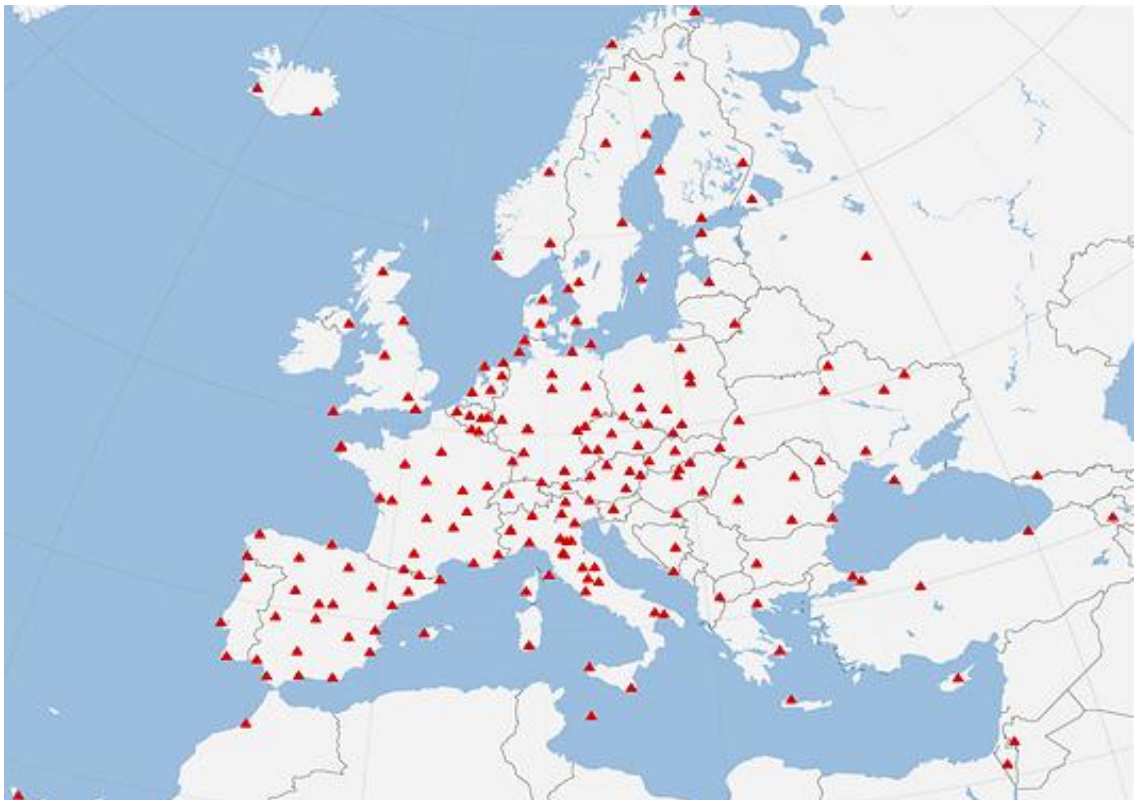
Kuva 1. ETRS89 -koordinaattijärjestelmän realisoinnissa ja ylläpidossa käytettävä pysyvien GPS-asemien verkko, EPN (Global reference frames 2009).
