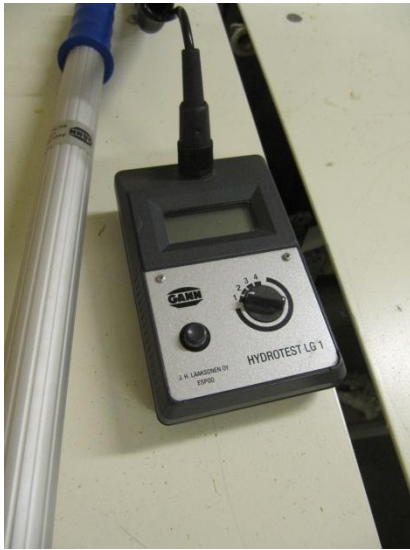
Kuvio 10. GANN Hydrotest LG 1-mittari ja LB70-teleskooppipinta-anturi
