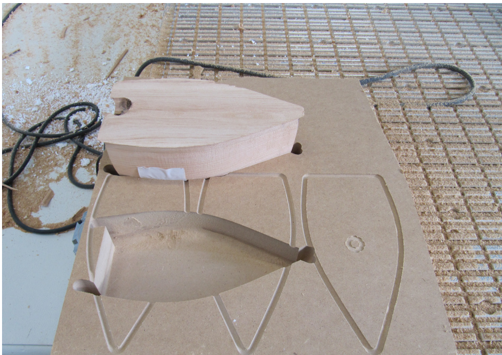
Jigin materiaalina on käytetty MDF -levyä.
