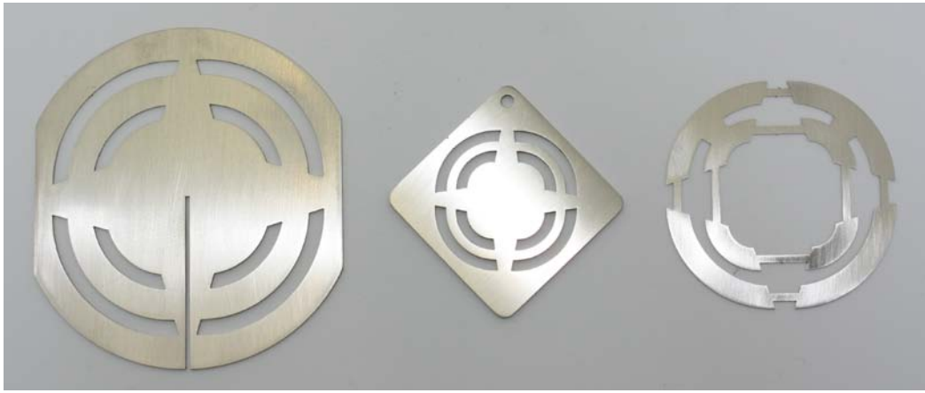
Kuva 16. Teräksestä valmistetut prototyypit (Nissinen, 2012).
