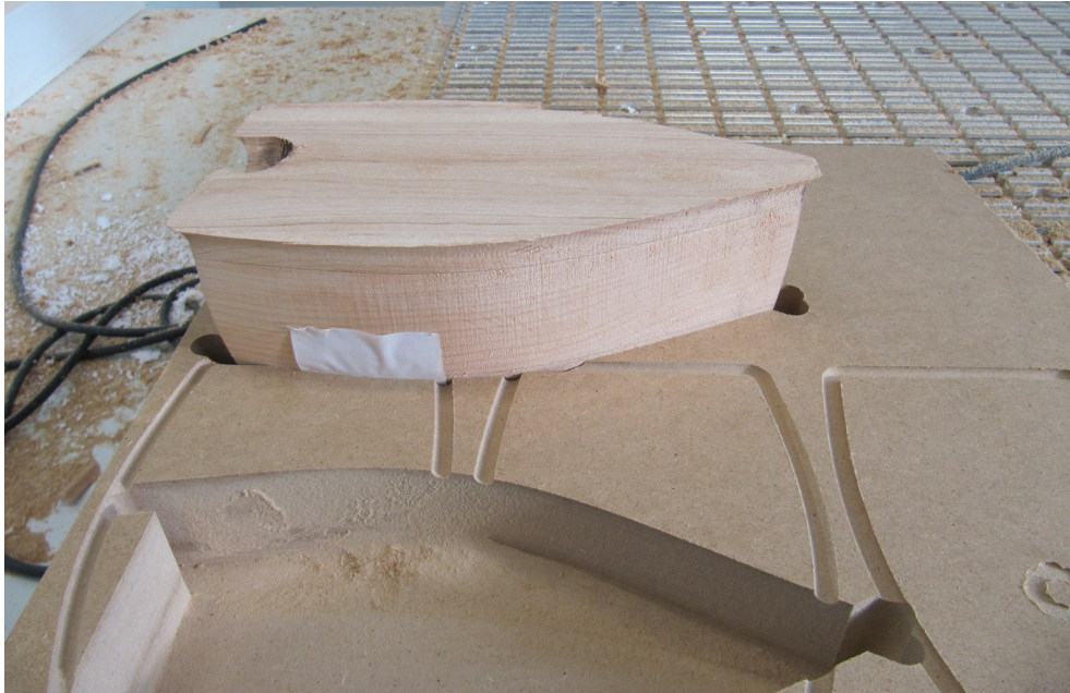
Jigi eli kiinnitin, jonka avulla kappaleet saadaan pysymään paikoillaan työstön ajan.
