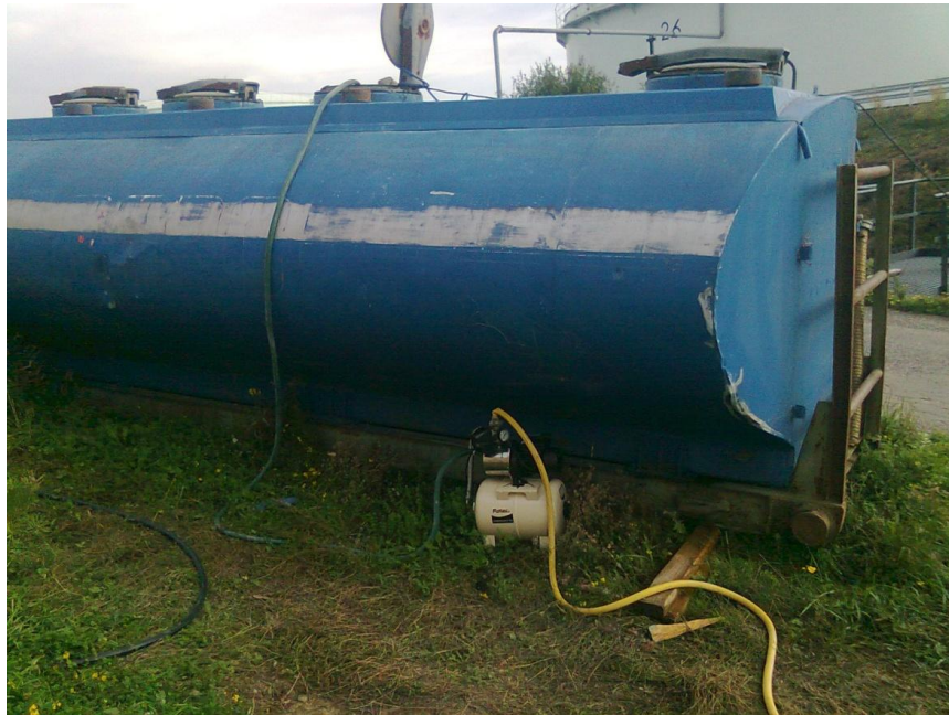
Kuva 8. Vesisäiliö ja painekompressori vesipiikkausta varten.
