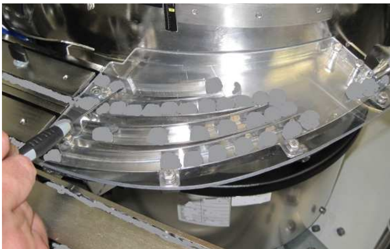
Kuva 20. Komponentit siirtyvät haaroittimesta lineaarille, jossa liitospalan epä-jatkuvuuskohta ennen lineaaria aiheuttaa tukoksia.
