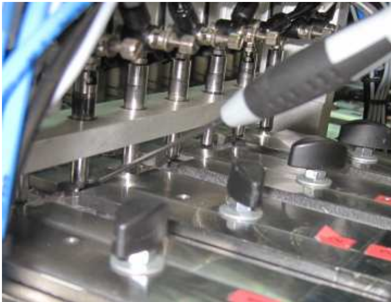
Kuva 18. Lineaarin päässä siltaosalla olevat stopparisylinterit laskevat vain yksittäisen komponentin erottelijaan.
