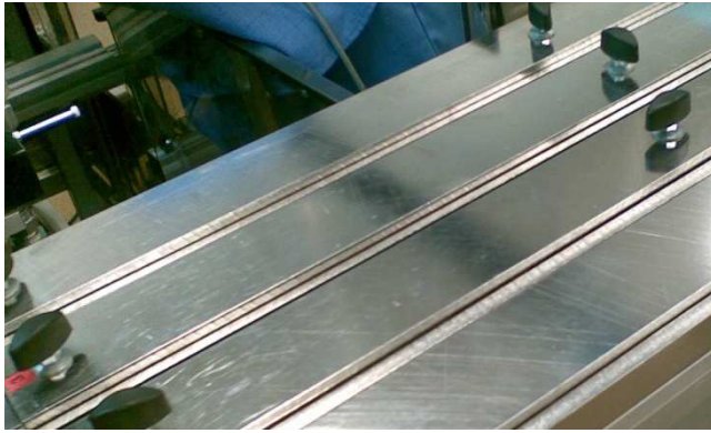
Kuva 9. Lineaarijohteet on suojattu pikakiinnitettävillä teräskansilla. Kansien läpinäkyvyys helpottaisi syöttöprosessin seuranta.
