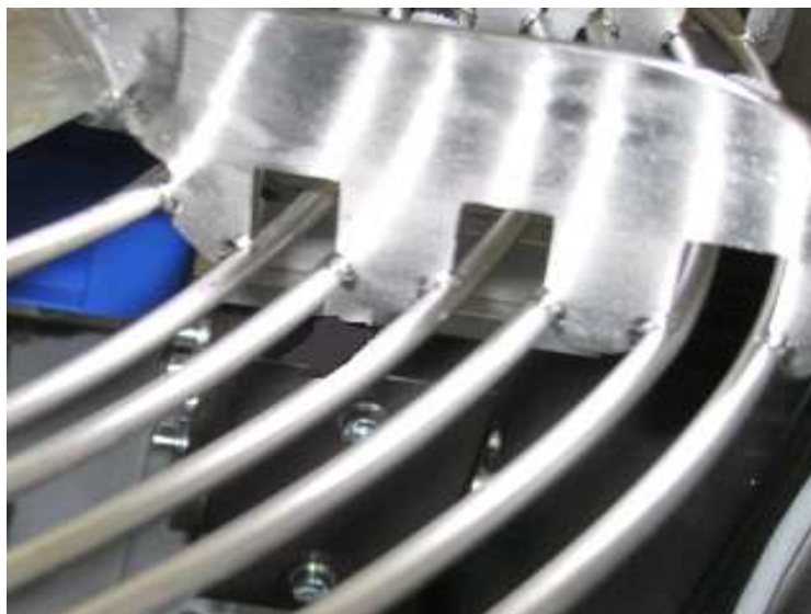
Kuva 16. "Haitarikytkimien" jumiutumisaikka tärjymaljalla.
