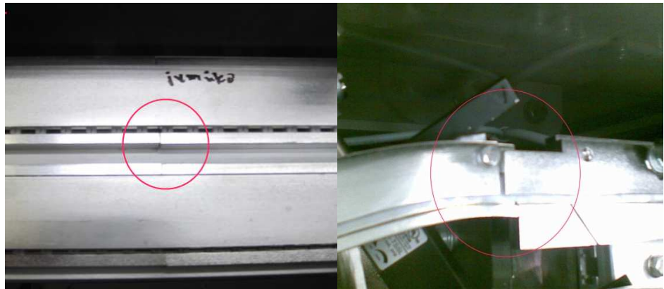
Kuva 12. Lineaarijohteiden epäjatkuvuuskohtia, joihin komponentit takertuvat helposti kiinni.
