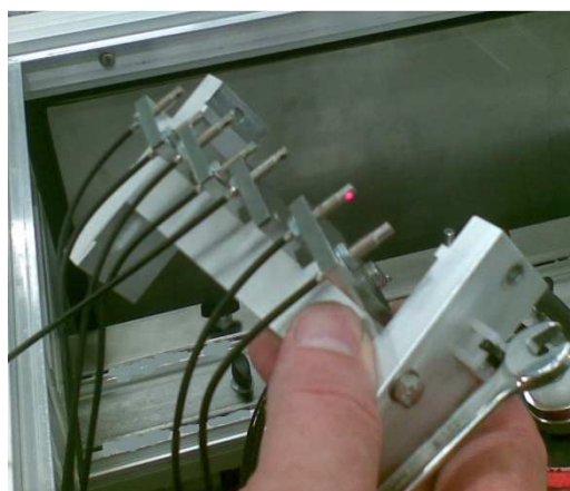
Kuva 14. Koko tuki jouduttiin irrottamaan valokuitujen säätöä varten.
