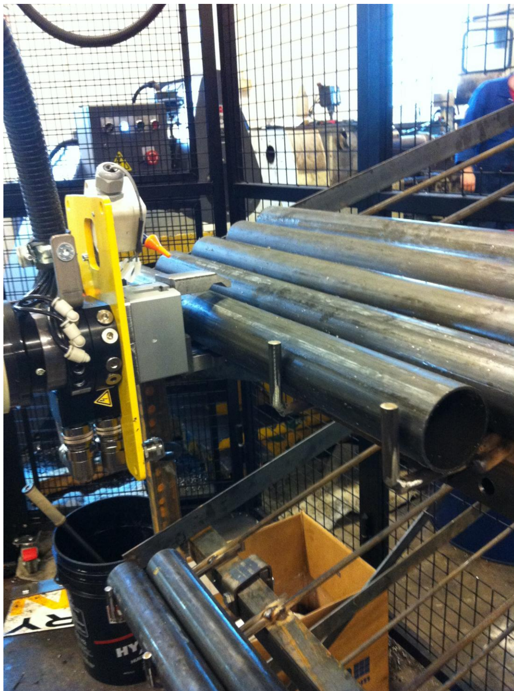
Kuva 30. Vaihe 1 – Robotti hakee kappaletta makasiinista.
