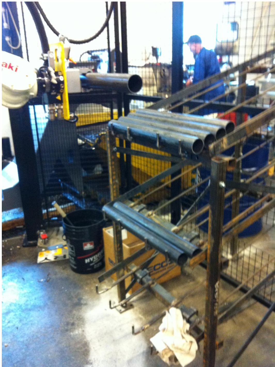
Kuva 31. Vaihe 1 – Robotti hakee kappaletta makasiinista.
