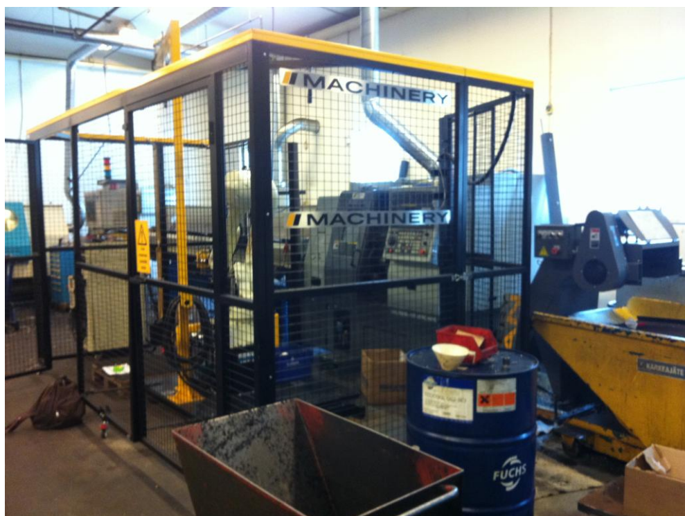
Kuva 14. Kilkanen Oy:n Machinery Man –solu RS020, jota ympäröi turva-aitaus.
