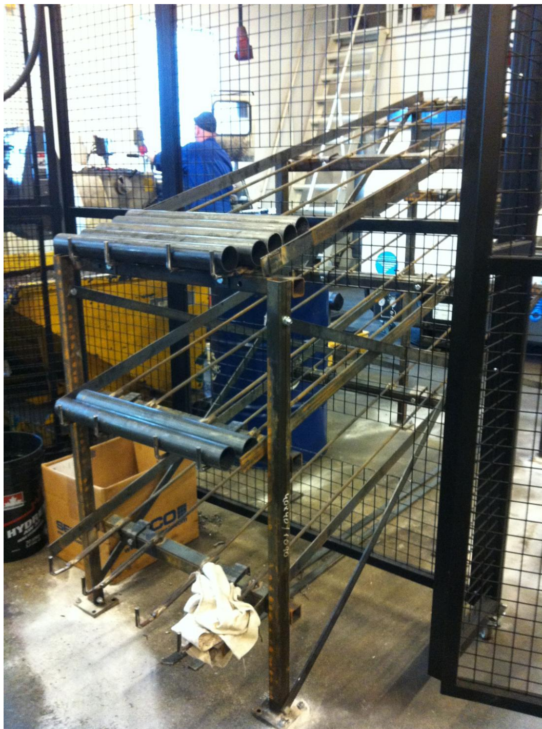
Kuva 28. Uusi aihiomakasiini koottuna ja asennettuna paikalleen.
