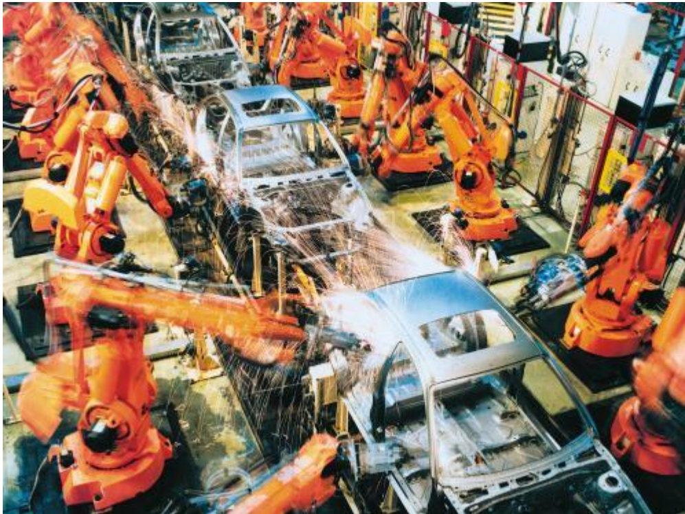
Kuva 2. Esimerkki tuotantolinjastosta, jossa tuotantosolut sekä tuotteen siirtäminen niiden välillä, ovat täysin automatisoitu. /22/.
