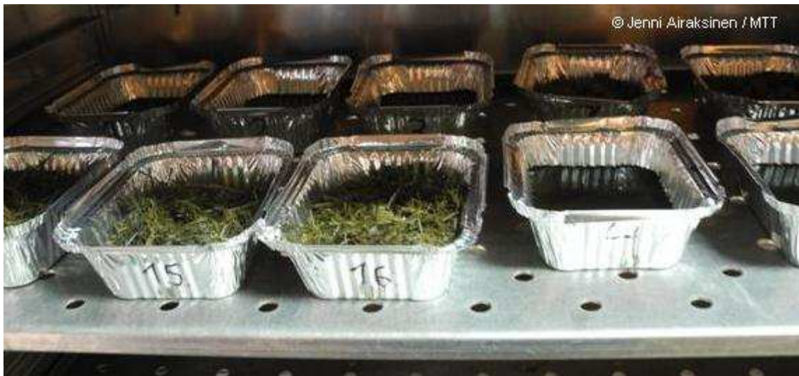
KUVIO 7. Kuiva-ainemäärittystä varten näytteet kuivatettiin kuivatusuunissa 105°C:ssa
