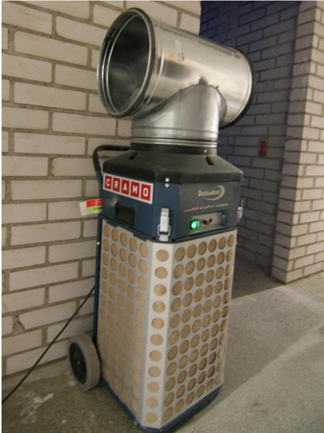
KUVA 8. HEPA-suodatukseen perustuva ilmanpuhdistin työmaakäytössä
