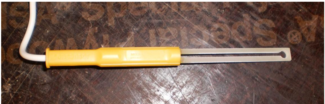
Kuva 11. Internetloggerin mitta-anturi (Kuva: Jere Toivonen.)
