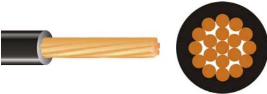
KUVA 2. Muutamalankainen johdin (Draka NK Cables Oy 2008, muokattu)
