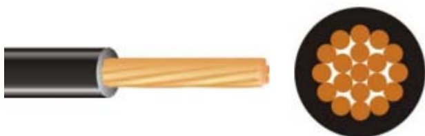
KUVA 12. MK 90 – johtimen rakenne (Draka NK Cables Oy 2008, muokattu)
