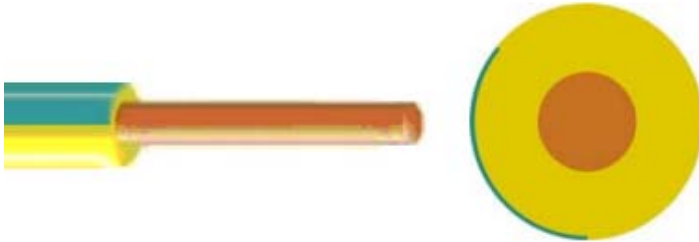
KUVA 1. Yksilankainen johdin (Draka NK Cables Oy 2008, muokattu)
