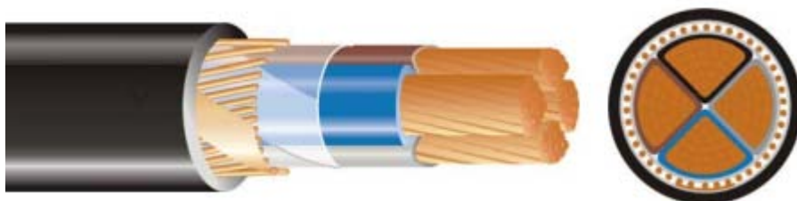
KUVA 13. MCMK-kaapelin rakenne (Draka NK Cables Oy 2008, muokattu)
