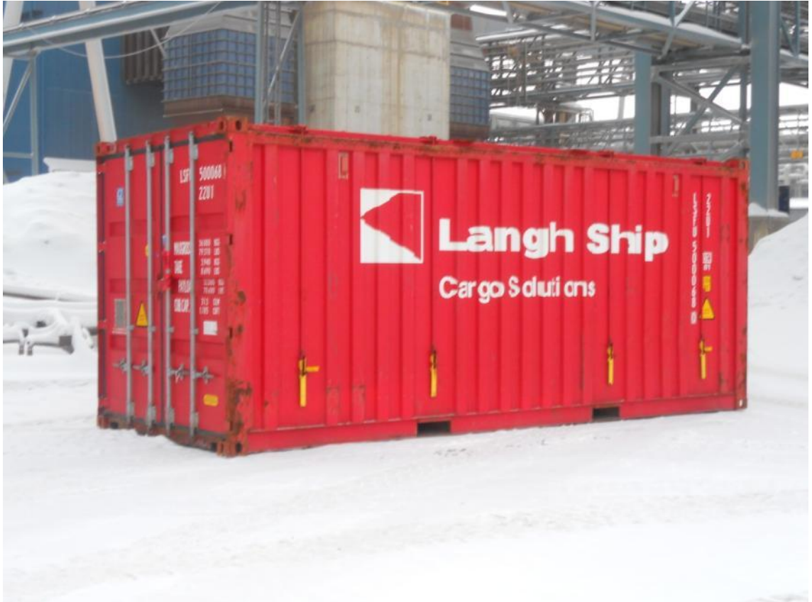
Kuva 5. Langh Ship 5-sarjan päädyistä ja päältä avattava kontti (Suopajärvi 2012.)
