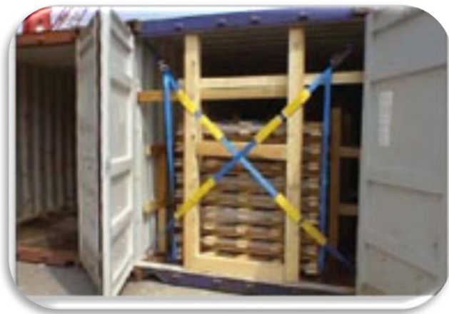
Kuva 4. Normaali kirvesmiehen puusidonta (Langh Ship 2011.)
