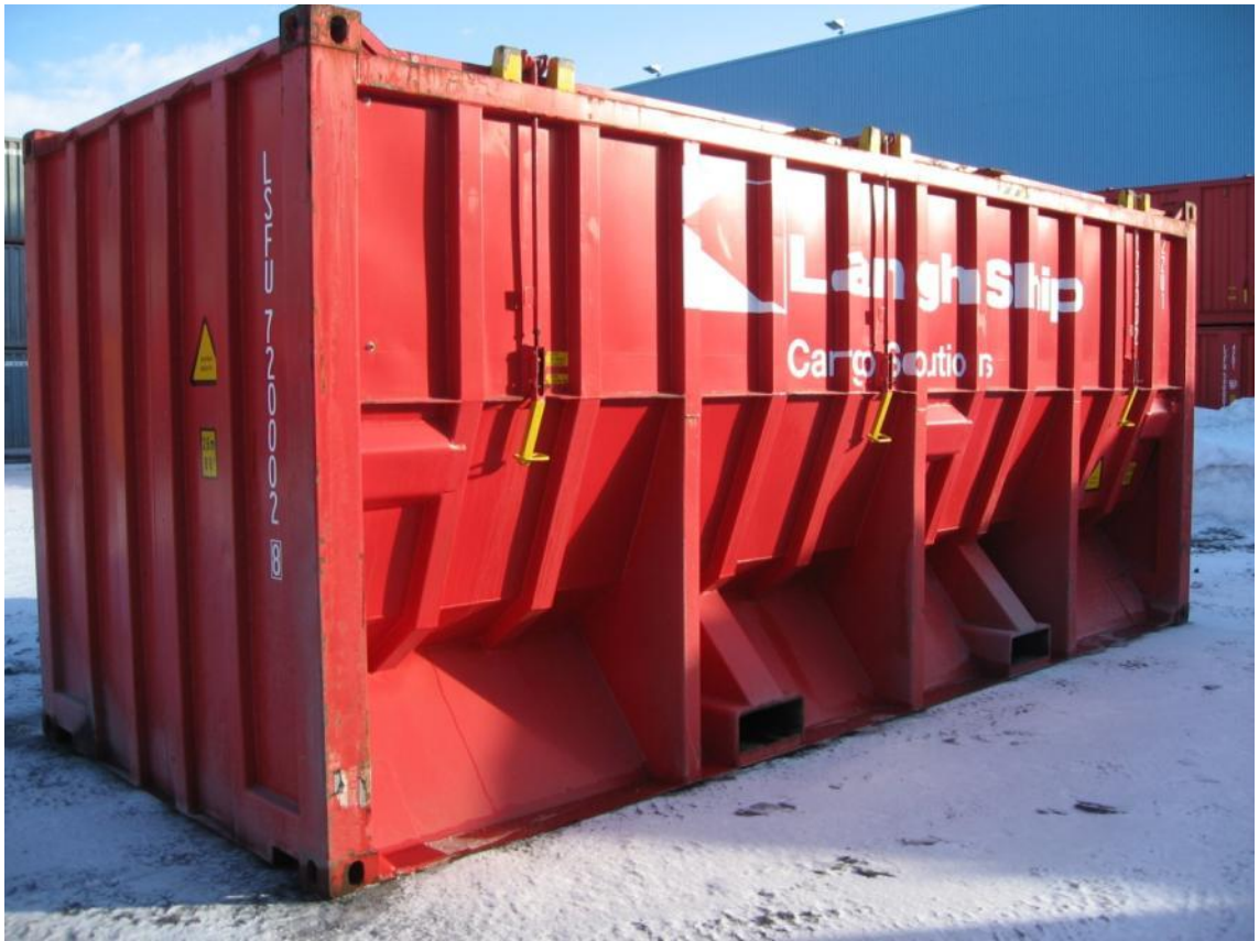
Kuva 7. Päältä lastattava 72-sarjan kourukontti (Suopajärvi 2012.)
