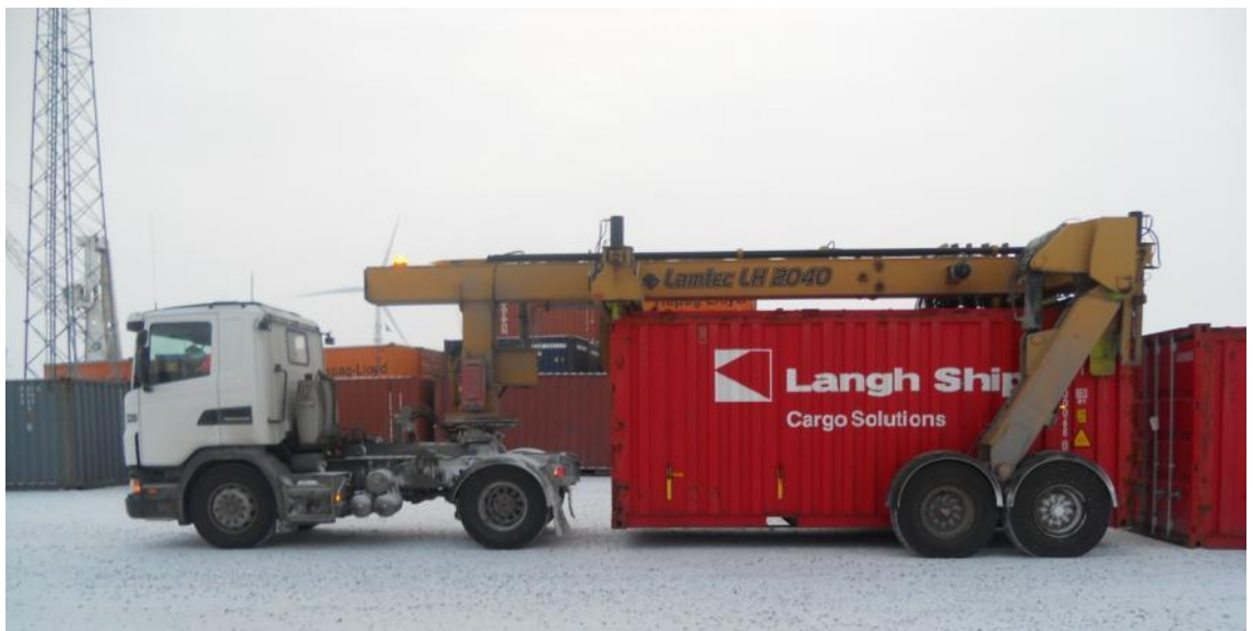
Kuva 10. Auto on nostanut kontin kyytiinsä (Suopajärvi 2012.)
