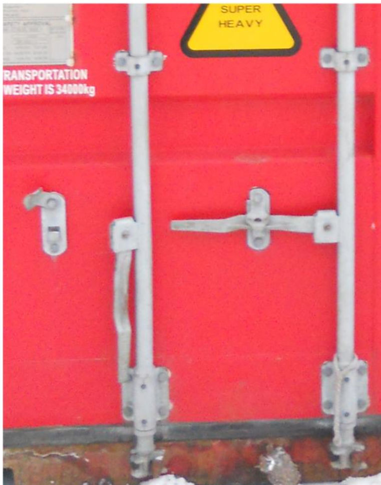
Kuva 26. Edestä avattavan kontin ovilukot läheltä. Lukot voi nähdä kauempaa kuvassa 5 (Suopajärvi 2012.)
