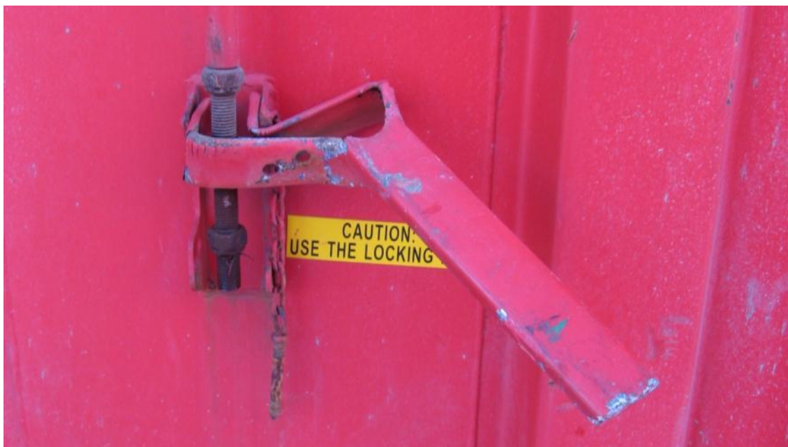
Kuva 30. Vaurioitunut kattosalvan kahva (Suopajärvi 2012.)
