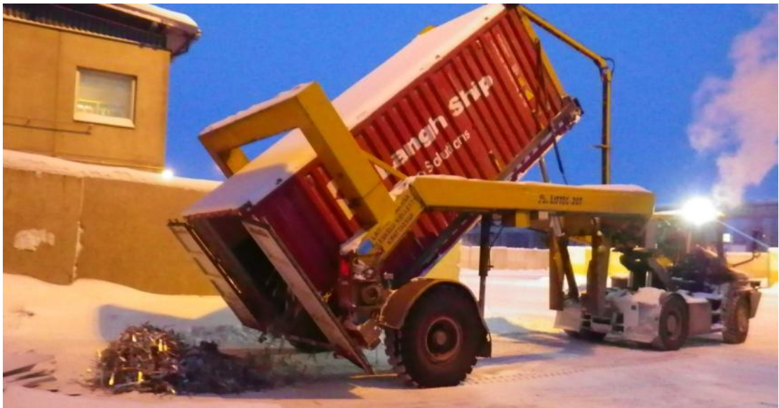
Kuva 17. Konttia tyhjennetään kippaamalla (Salmi 2012.)
