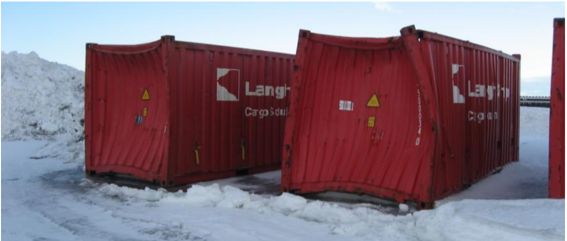
Kuva 13. Aaltojen vaurioittamia teräskontteja satamassa siirrettyä sivummalle. (Suopajärvi 2012.)
