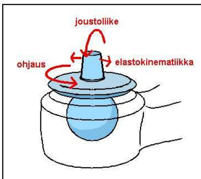
Kuva 48. Pallonivelen liikkeen vapausasteet
