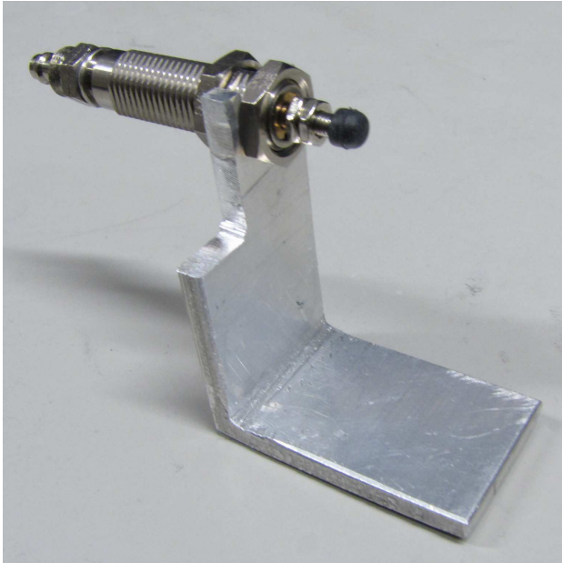
KUVA 19. Valittu paineilmasylinteri ja pidike
