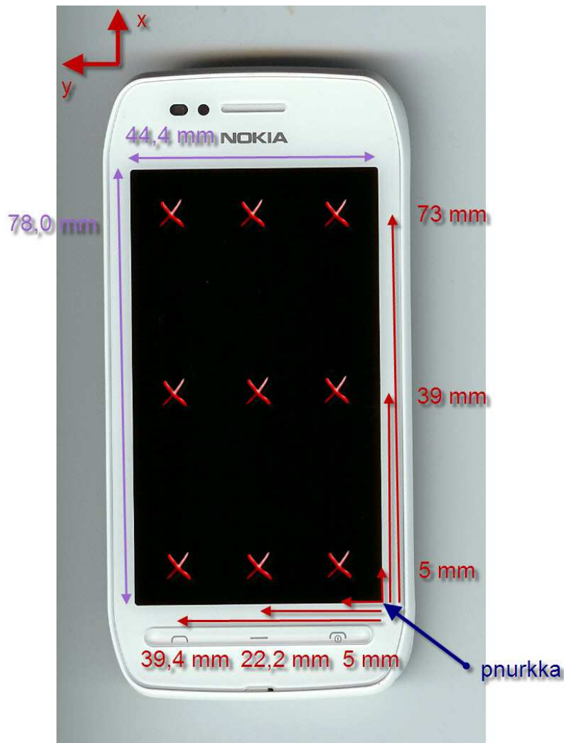
KUVA 24. Teräskuulan osumapisteiden x- ja y-suuntaiset etäisyydet näytön nurkkapisteestä
