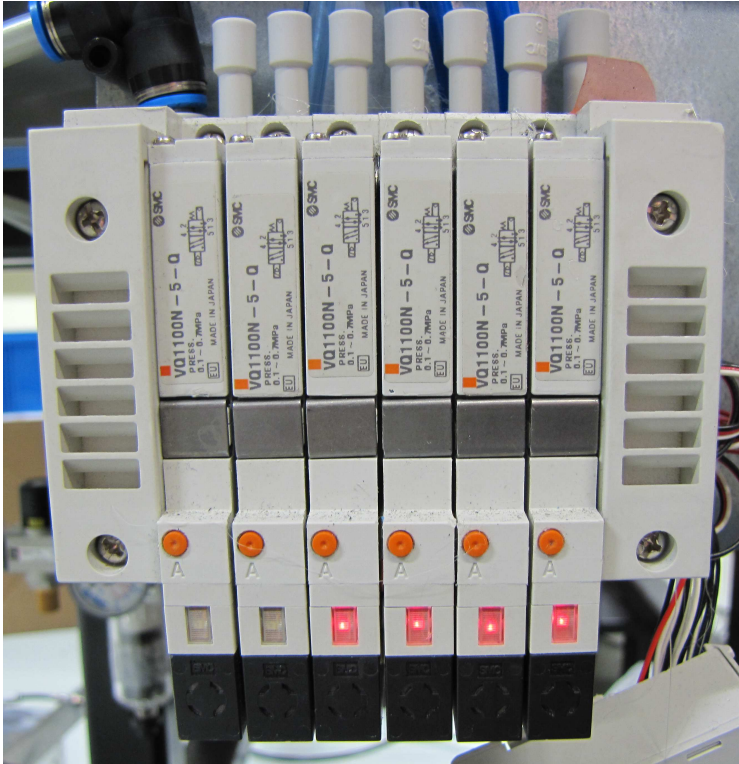
KUVA 21. Magneettiventtiilit digitaalilähtöjen pneumatiikan ohjaukseen
