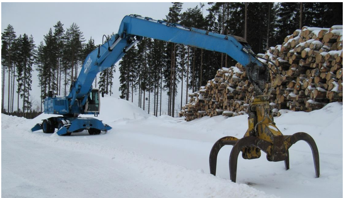
KUVA 7. Puutavaranosturi on varaston korottamista varten.
