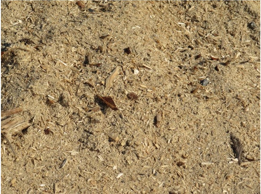
KUVA 11. Purua voidaan käyttää 3–4 kertaa varaston eristämiseen.
