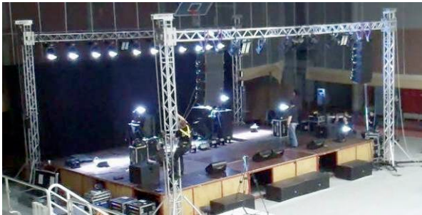
Kuvio 19. Line Array (EV) ripustettuna trussiin ja subwoofereit lavan edessä. SyysX-tapahtuma 2011, Kajaanihalli.
