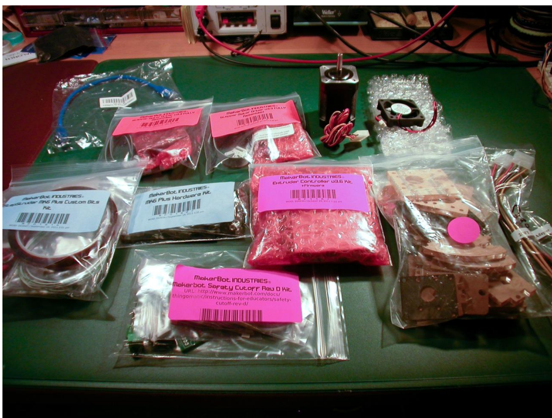
KUVA 11. Stepstruder MK6+:n osat
