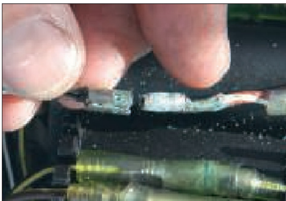
Kuva 20. Hapettuneet liittimet. Hapettuneet liittimet aiheuttavat ylimenoresistanssia, jonka seurauksena syntyy jännitehäviöitä. Liittimien puhtaous on sähköjärjestelmän oikean toiminnan kannalta elintärkeää. (Calder 2012, 55)
