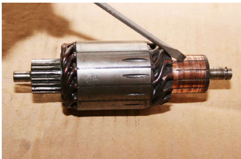
Kuva 9. Käynnistimen ankkuri. Jos ankkurin käämityksessä on viiruja tai urautumia kertoo se laakereiden kulumisesta. Kuvan ankkurin käämityksessä ei ole havaittavissa kulumaa. Kollektorin urat pystyy tarvittaessa puhdistamaan ruuvimeisselin kärjellä. (Karkinen 2011, 49)
