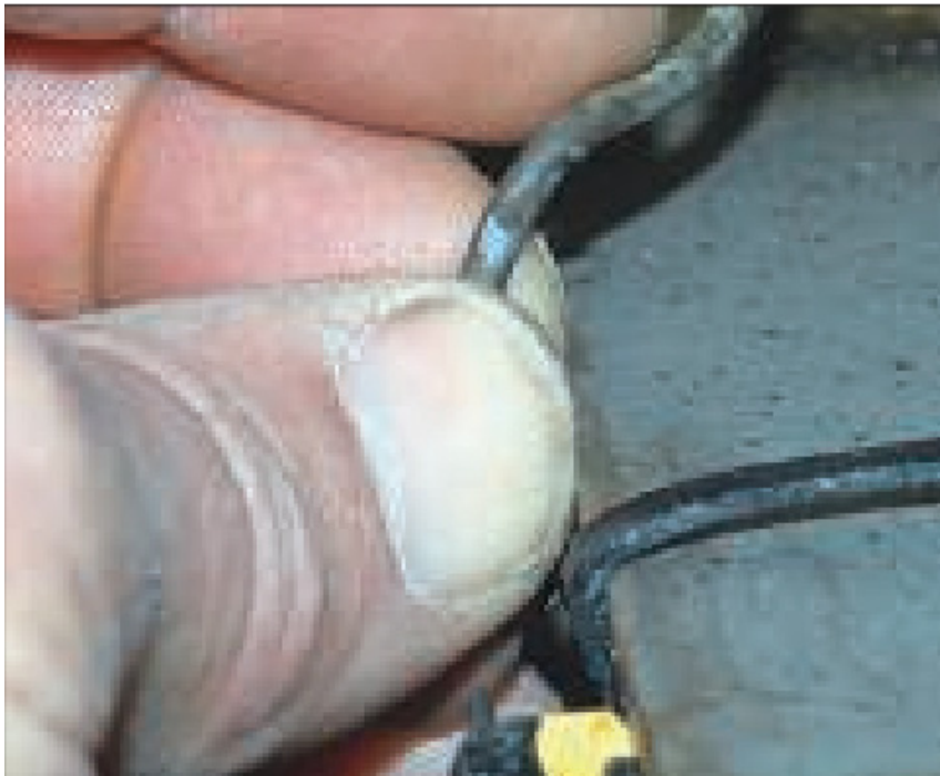
Kuva 11. Johtimen eristeen hankauma. Johtimen eristeen jatkuva hankautuminen teräviä reunoja vasten johtaa lopulta eristeen rikkoutumiseen ja oikosulkuun. (Calder 2012, 61)
