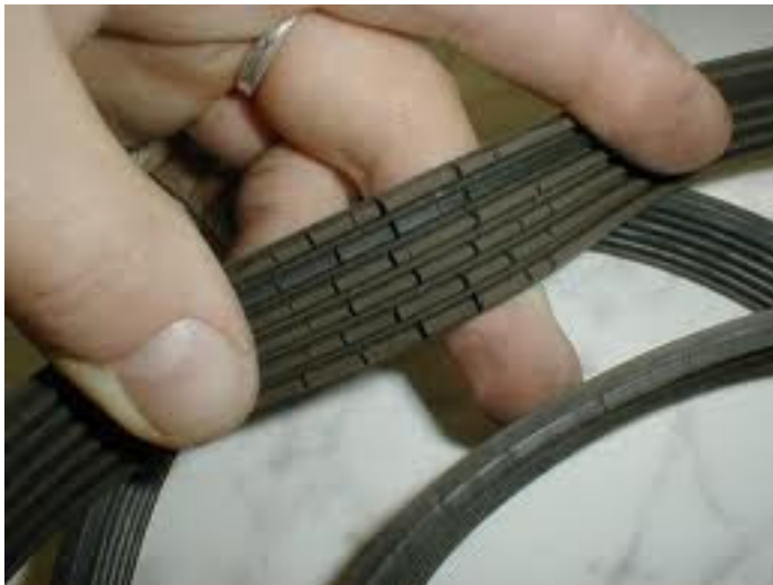
Kuva 6. Halkeillut moniurahihna. Jos laturin hihnassa on havaittavissa halkeamia tulee se vaihtaa uuteen. (Peugeot-foorumi 20.4.2012)
