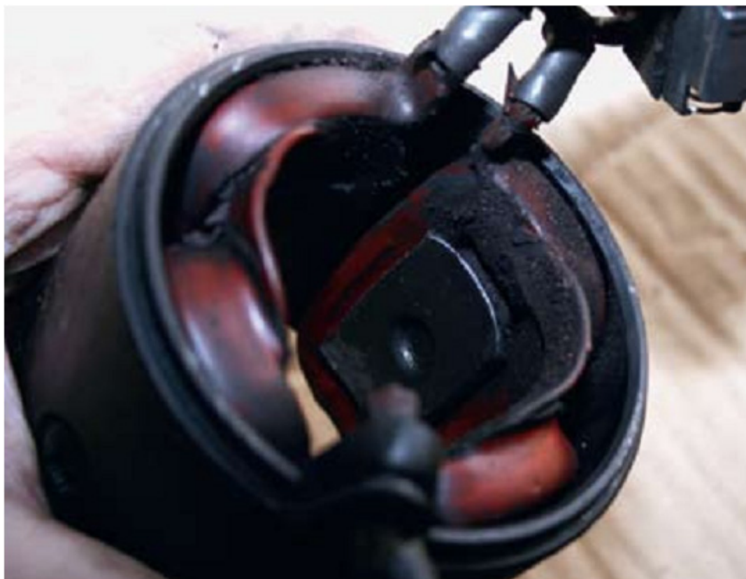
Kuva 10. Likaantunut staattorin käämitys. Jos käynnistin joudutaan purkamaan, kannattaa kaikki osat puhdistaa huolellisesti. Käynnistimen osat likaantuvat hiiliharjoista irrottuvan pölyn seurauksena. (Karkinen 2011, 49)
