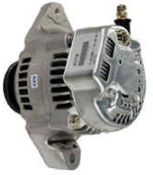
Kuva 7. Puhdas generaattori. Generaattorin ulkopuoli puhdistaa säännöllisesti. Jos generaattoria pestään tulee vedellä, tulee veden ruiskuttamista sisään kuvassa näkyvistä jäähdytysilma-aukoista välttää. (Kk-holding 20.4.2012)
