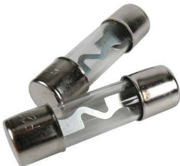
Kuva 23. Lasisulakkeet. Jos veneessä käytetään lasisulakkeita, tulee sulakkeiden liitospinnat joka kevät puhdistaa ennen veneen vesillelaskua. Liitospintojen tulee näyttää kirkkailta. (Motonet Oy)
