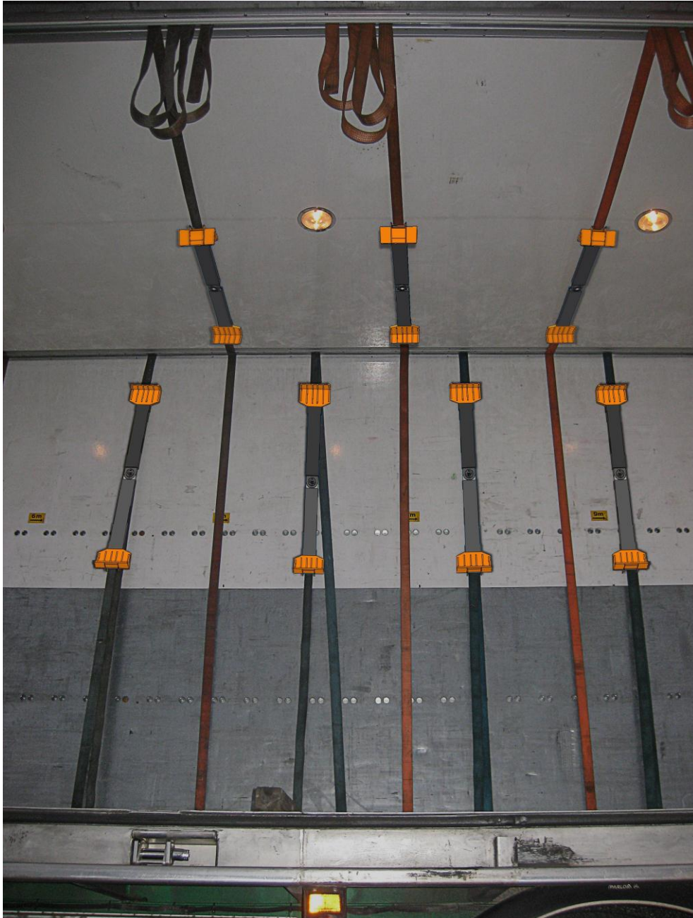
KUVIO 19. Kulmasuojalaitteen ensiasennus/säilytys.
