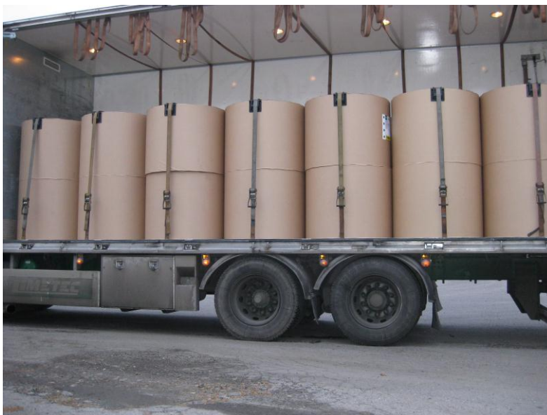
KUVIO 4. Kulmasuojien käyttöperiaate.
