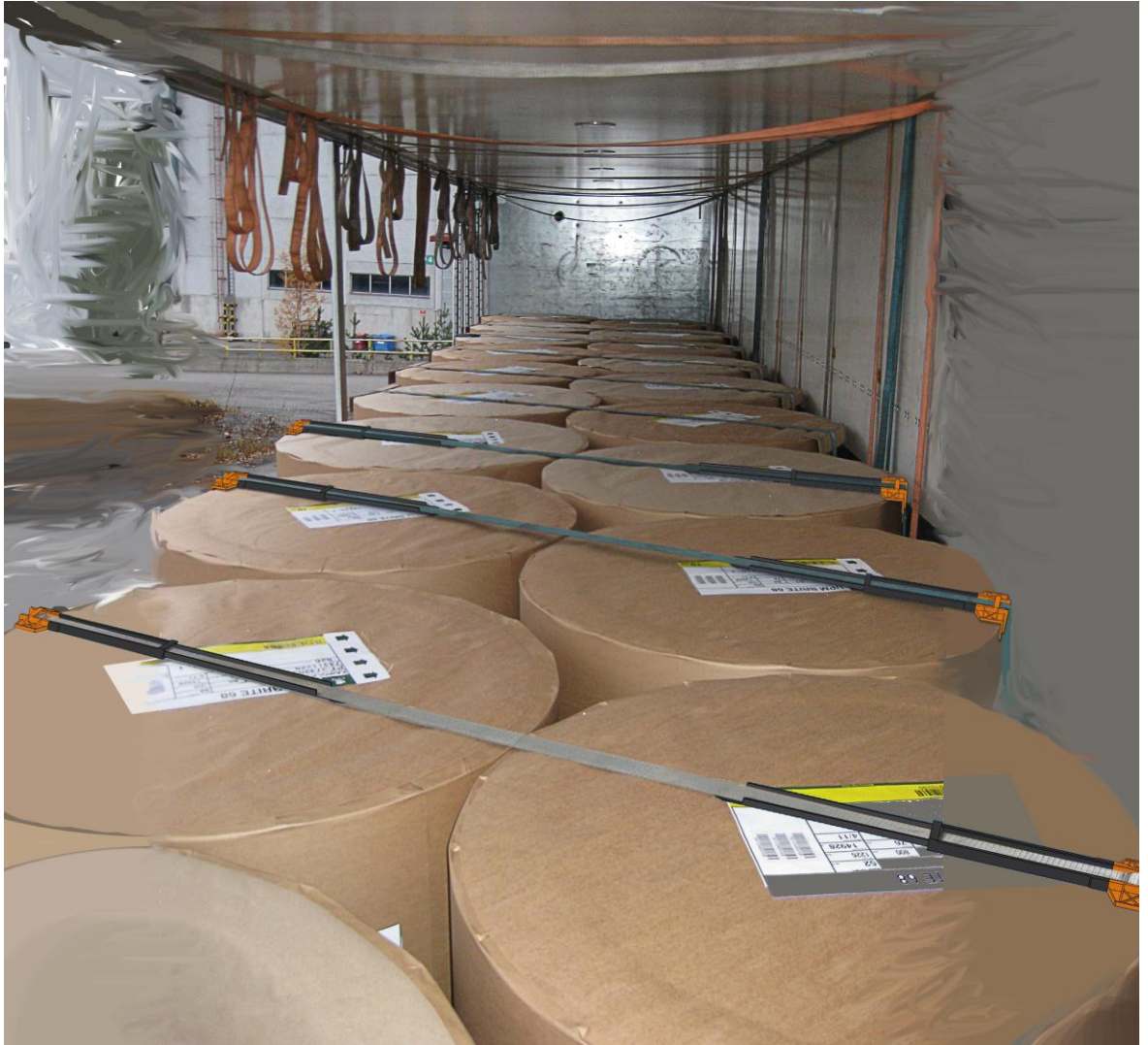
KUVIO 20. Kulmasuojalaitteen asennus sidontavaiheessa.
