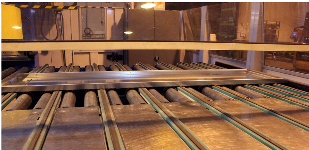
Kuva 19. TUT-bufferointipöytä, jollaista käytetään usein single unit -laitteissa (Taneli Mero, 2012)
