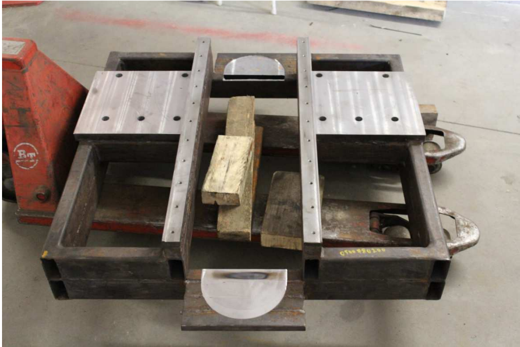
Kuva 1. Käytännössä toteutettu jyrsinkoneen alarunko.
