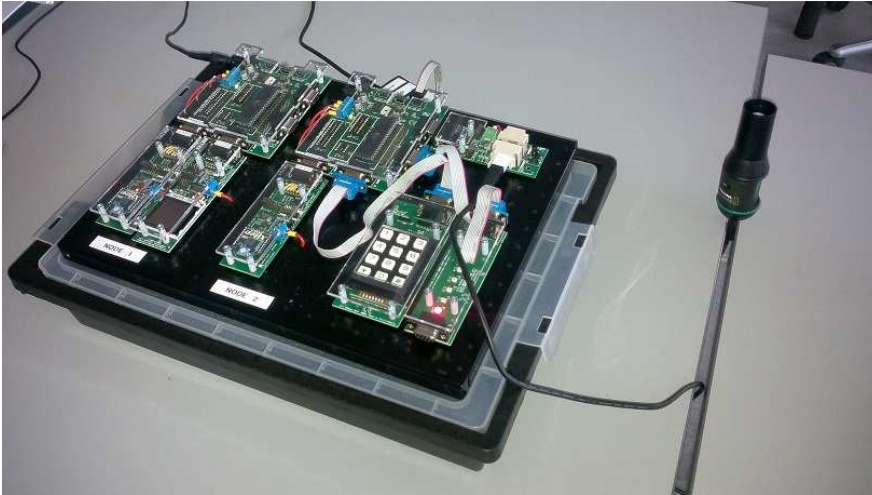
KUVA 30. Happisensori kytkettynä päätelaitteen sensoriliitäntälohkoon
