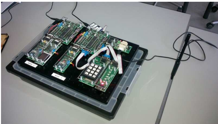
KUVA 25. Kosteussensori kytkettynä päätelaitteen sensoriliitäntälohkoon
