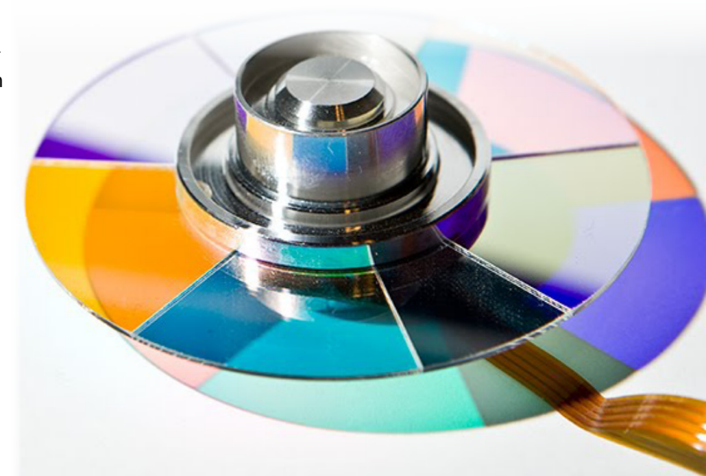
Kuva 13. Samsung HLR4667 projektorin väripyörä (Svmoneypit 2010)
