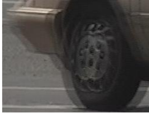
Kuva 17. Lomitettua videokuva progressiivisella näytöllä (Wikipedia 2012)
