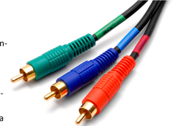
Kuva 23. YPbPr komponenttisygnalia-kaapeli (Wikipedia 2012)
