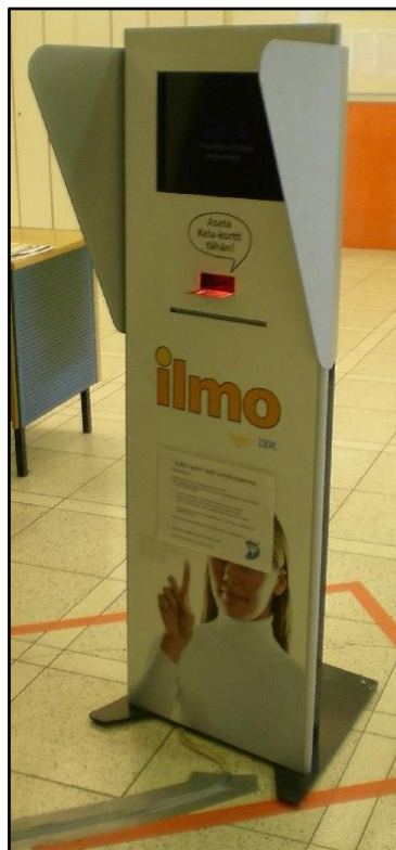
Kuva 2. Syöpätautien klinikan sisääntulokerroksen itseilmoittautumisautomaattiin (ILMO2) asennettiin metalliset sivustakatsomissuojat torstaina 5.4.2012.
