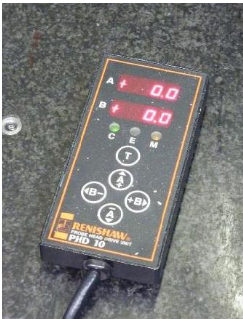
Kuvio 8. Mittausanturin ohjauskapula, Renishaw PHD 10.
