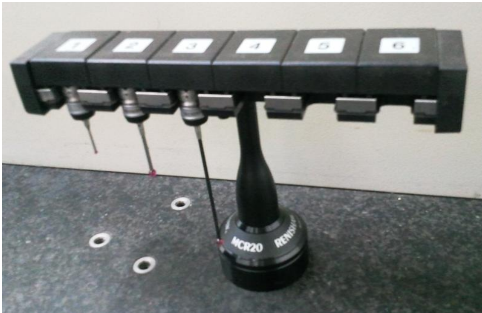
Kuvio 6. Vaihtomakasiini Renishaw MCR20.
