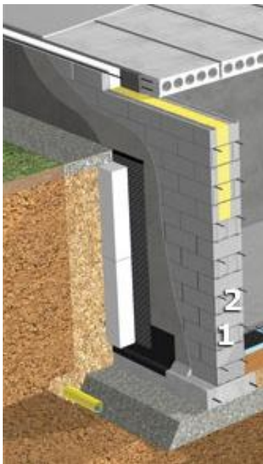
KUVA 8. Kellarillisen ulkoseinän vedeneristys ja salaojituksen toteutus (weber 2012)
