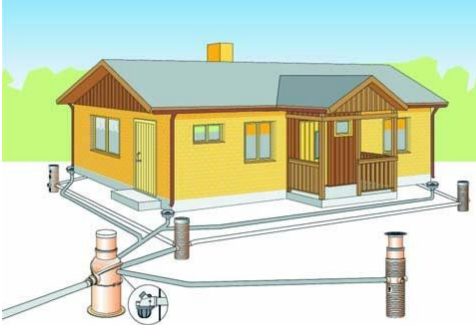
KUVA 7. Pientalon salaoja- ja sadevesijärjestelmän periaate (Rakentaja 2011)
