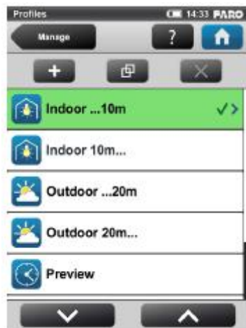
KUVIO 3. Kosketusnäyttö ja skannausprofiilin valinta (FARO laser scanner focus 3D Manual 2011, 58)
