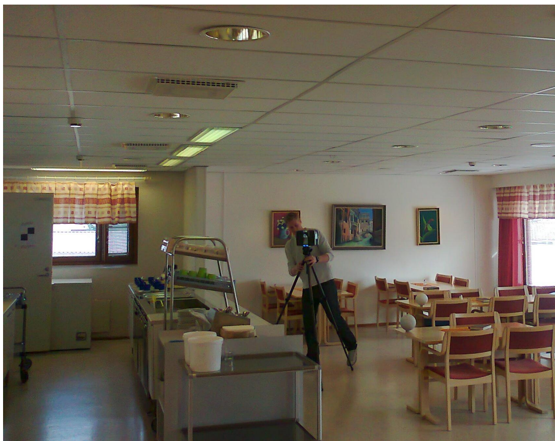
KUVIO 9. Laserkeilausta ruokailusalista, jonka pöydille on sijoitettu tähyspalloja
