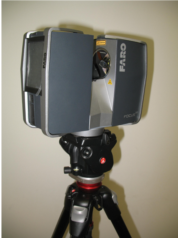
KUVIO 2. FARO focus 3D laserkeilain jalustaan kiinnitettynä
