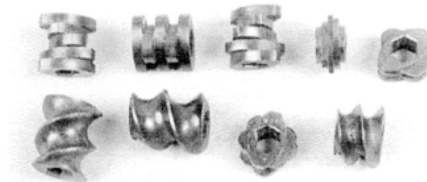
KUVIO 3. Erilaisia kuljetus- ja sekoituselementtejä (Baker ym. 2001, 185.)
