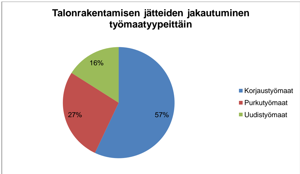
Kuvio 4: Talonrakentamisen jätteiden jakautuminen työmaatyypeittäin vuonna 2007 (Talonrakentamisen ympäristömittari)
