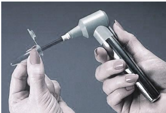
Kuva 18. Pellet Pestle –mikrosentrifugiputkisekoittaja. (Pellet Pestle Cordles Motor 2011.)
