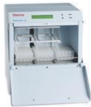
Kuva 6. KingFisher-tuoteperheen magneettipartikkeliprosessorit. Vasemmalta lähtien kuvattuna KingFisher, KingFisher mL, KingFisher Flex ja KingFisher Duo. (Lamberg 2012: 6, muokattu.)
