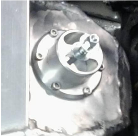
KUVA 18. Lisäilmaventtiili painekotelon kannessa
