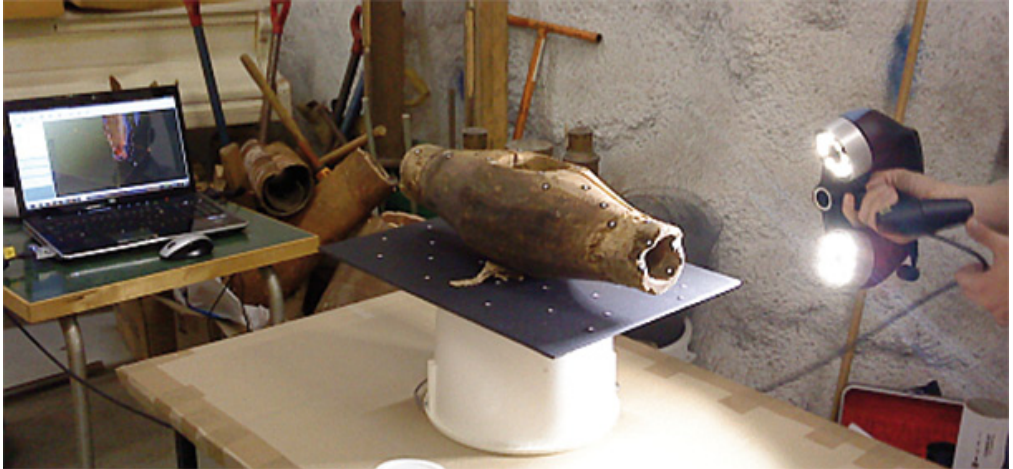
KUVA 5. Skannausta kädessä pidettävällä optisella skannerilla (Hannus & Palonen 2011)
