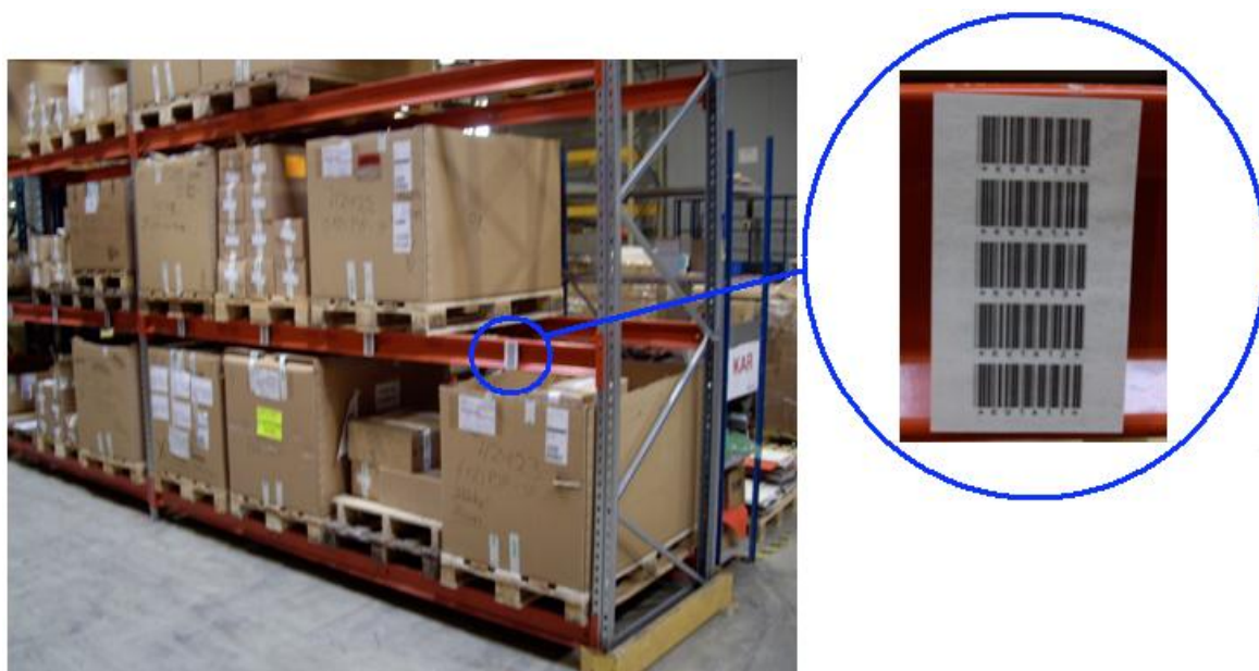
KUVA 7. Esimerkki viivakoodikilven sijoittamisesta varastohyllyyn. [5]
