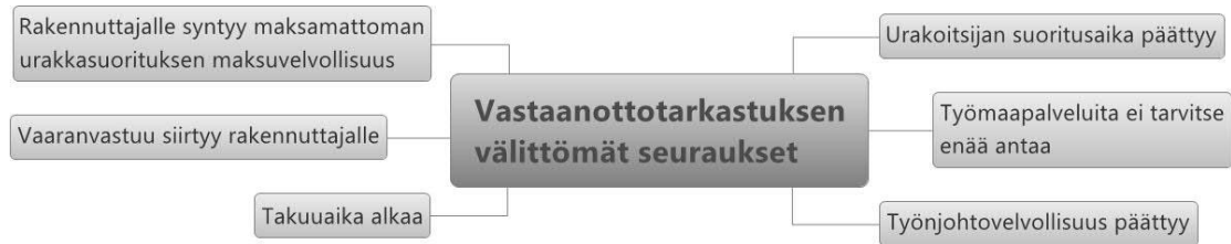
KUVA 15. Vastaanottotarkastuksen välittömät seuraukset (Kankainen – Junnonen 2004, 87)
