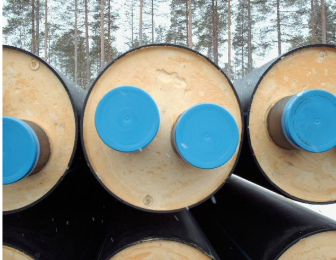
KUVIO 4. Kaukolämpöputki: virtausputket, eristekerros ja suojuakuori
