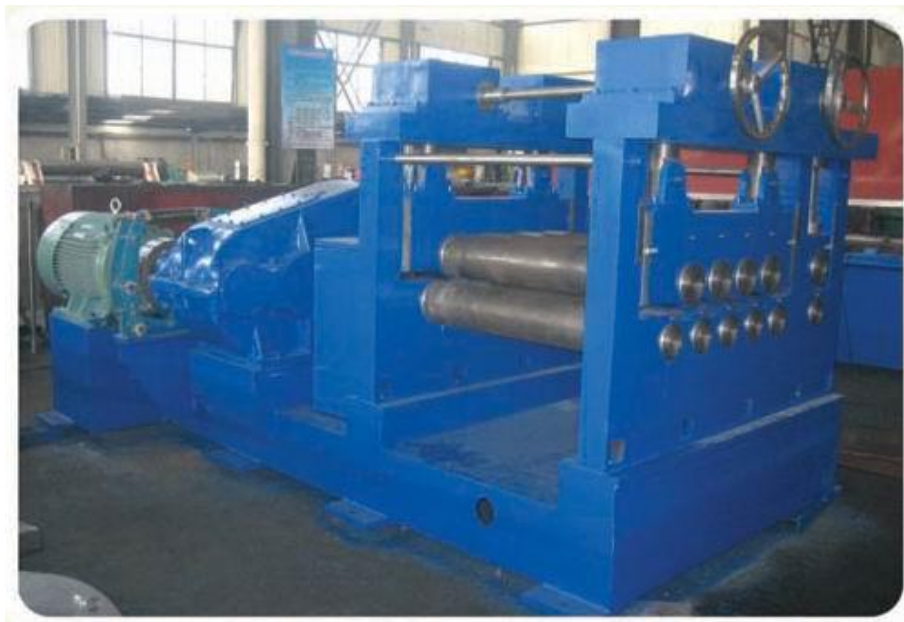
Kuva 8 Kylmäoikaisukoneen rakenne. (Jiangsu Junrong Heavy Industry Machinery Co., LTD, 2012)
