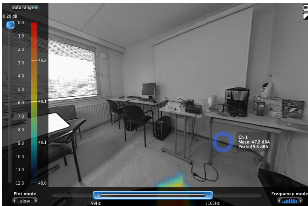
KUVA 20. Askelääneneristävyys seinän ja välipohjan liittymässä
