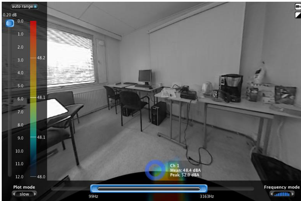
KUVA 21. Askelääneneristävyys lattialla noin metrin päässä seinästä
