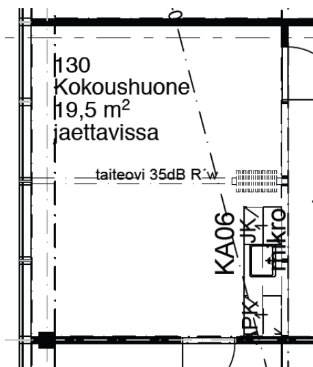
KUVA 8. Neuvotteluhuone 130:n pohjapiirros (Oulun kaupungin rakennusvalvonta. 2009.)
