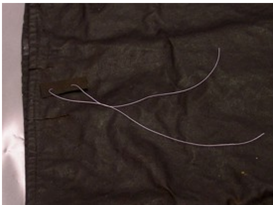
Kuva 60. Viiltovaurio 4.23 ja ohjauslangalla varustettu tukitilkku.
