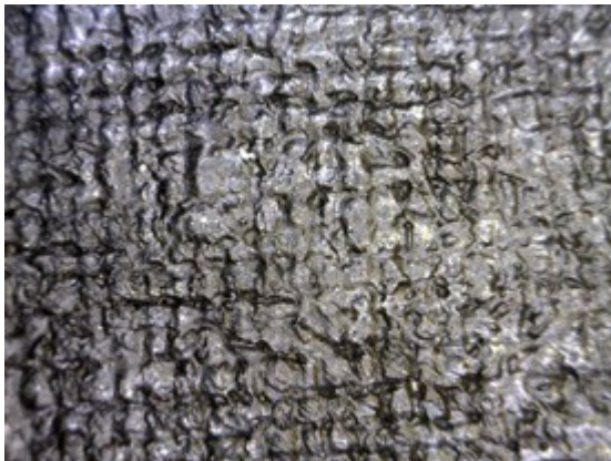
Kuva 48. Takin kangas kostealla sienellä pyyhkimisen jälkeen, suurennos 55-kertainen.
