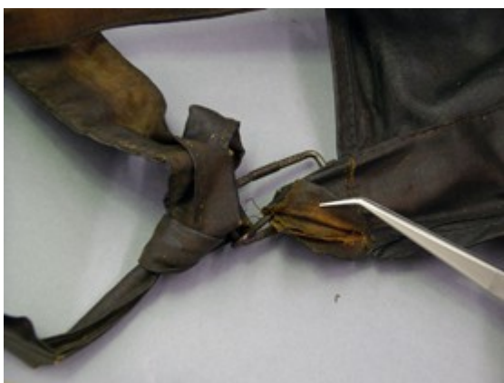
Kuva 63. Vasemman soljen kiinnitys osittain revennyt.
