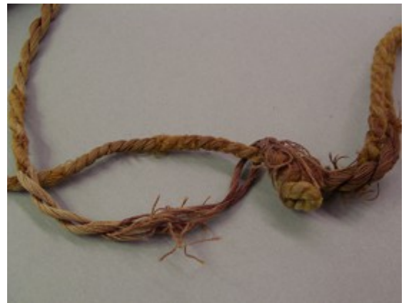
Kuva 45. Kuluneet kiinnitysna- rut.
