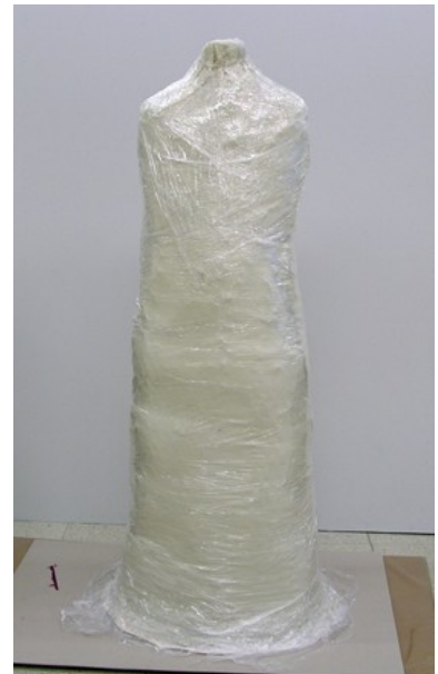
Kuva 76. Valmis muotti trikoolla ja polyeteenikelmulla päällystettynä.
