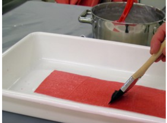
Kuva 77. Vehnätärkkelyksen levitys siveltimellä.
