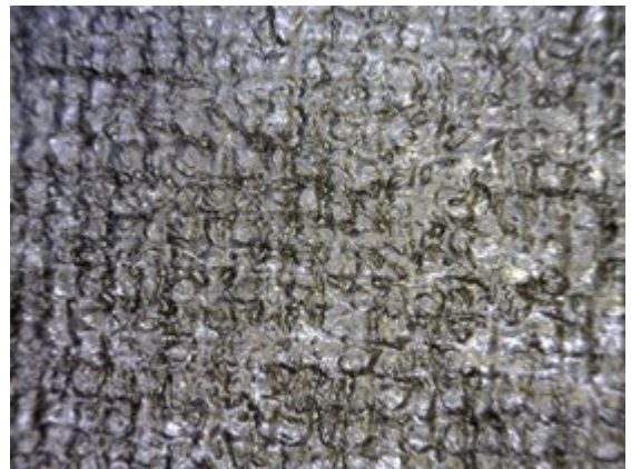
Kuva 47. Takin kangas imuroinnin jälkeen, suurennos 55-kertainen.
