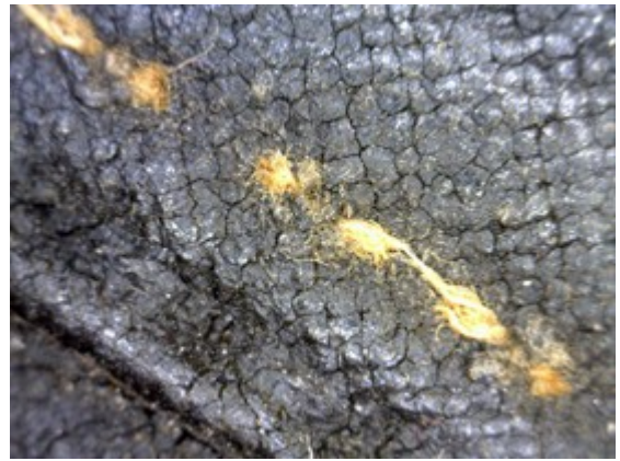
Kuva 43. Krakeloitunut pinta ja haurastunut ompelulanka, suurennos 55-kertainen.
