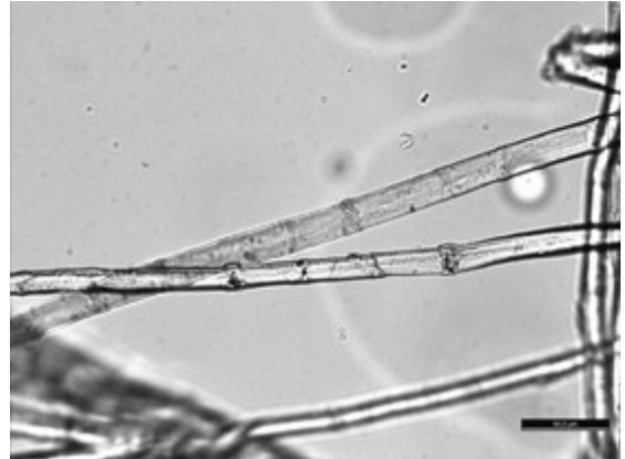
Kuva 30. Kuitunäyte beigestä käsinompelulangasta, suurennos 200-kertainen.
