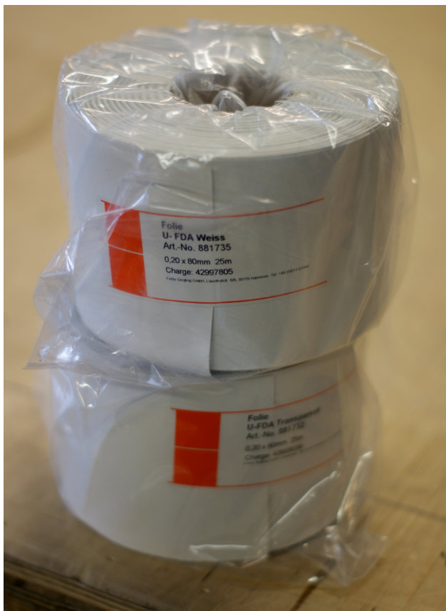
Kuva 18. Valkoista uretaaniliitosfoliota rullassa.
