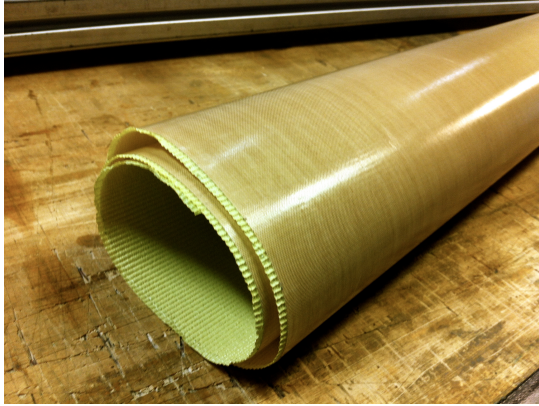
Kuva 12. Lasikuidulla vahvistettua teflonteippiä.
