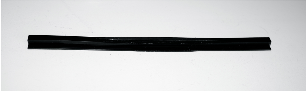
Kuva 10. Kuvasta huomaa, kuinka lämpö ja paine on kasvanut liian suuriksi POM-materiaalista tehdylle reunapalalle.
