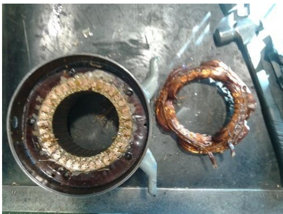
Kuva 12. Käänityksen otsa on katkaistu
