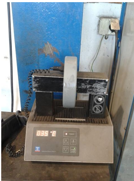
Kuva 18. Laakerin lämmitys induktiokuumentimella
