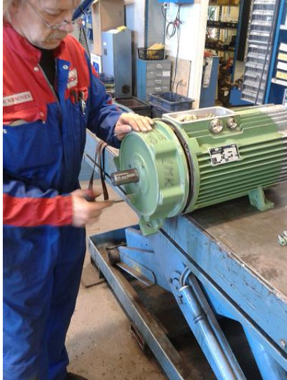
Kuva 23. D-pään kilpi kiinnitetään
