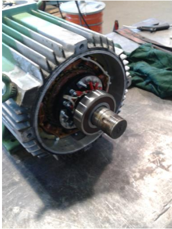
Kuva 19. Lämmin laakeri sopii akselille
