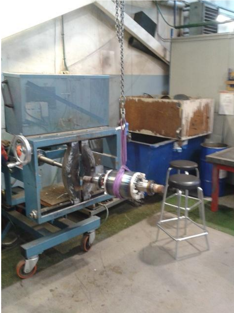
Kuva 11. Laakerien ulosveto hydraulisesti
