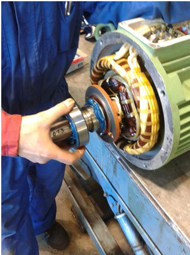
Kuva 20. D-pään laakeri asetetaan ilman lämmittämistä
