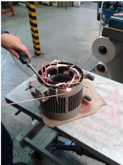
Kuva 15. Kytkennät hitsataan ja eristetään
