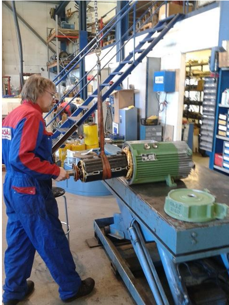
Kuva 17. Roottori asetetaan rungon sisään
