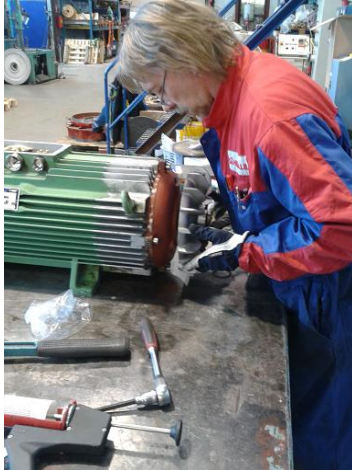
Kuva 25. Asetetaan tuuletin paikoilleen N-päähän
