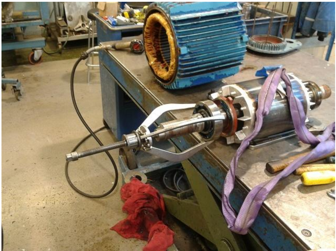
Kuva 10. Laakerien ulosveto mekaanisesti kiertämällä
