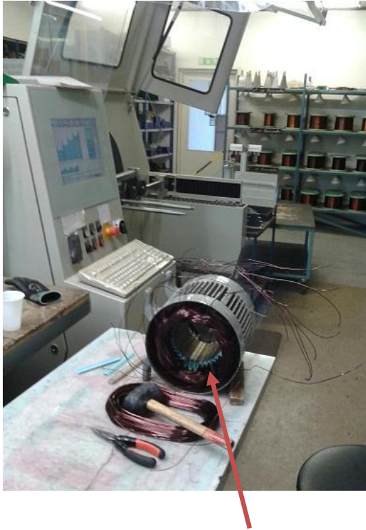
Kuva 14. Käämivyvyhdet, uraeristys (sininen paperi) ja taustalla vyyhtikone
