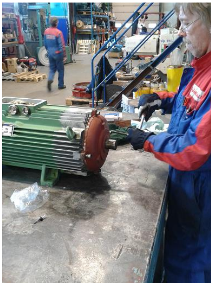
Kuva 22. N-pään kilven ja ruuvien asettaminen paikalleen
