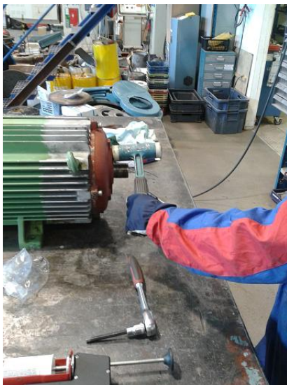
Kuva 24. Naputellaan vasaralla jännityksien poistamiseksi
