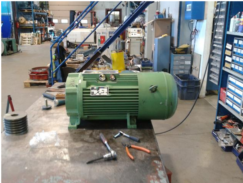
Kuva 26. Valmis sähkökone koekäyttöä varten
