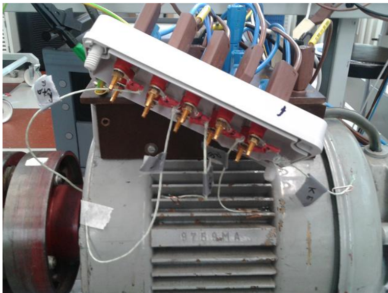
Kuva 41. Lämpötila-anturien sijoittelu kilpiin ja selkään
