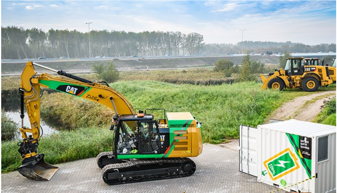
Kuva 4. CAT Z-line prototyyppi akkukäyttöisestä kaivinkoneesta ja pikalatauskontti.
