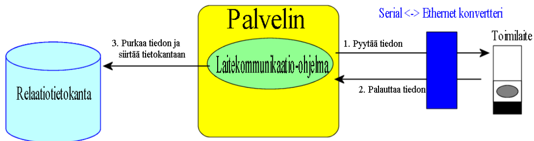
Kuvio 1. Laitetkommunikaatio-ohjelman tiedonpyyntö toimilaitteelta.
