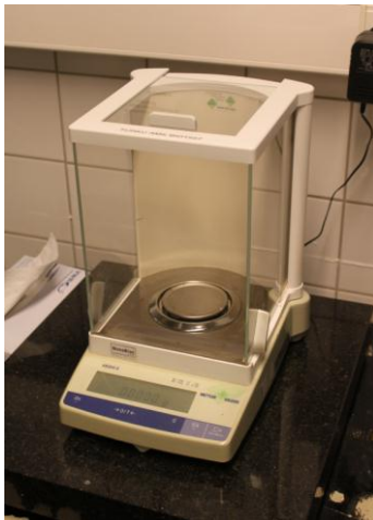
Kuva 1. Pipetinkalibroinneissa käytettävä vaaka, Mettler Toledo AB204-s.
