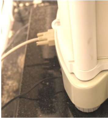
Kuva 42. Mettler Toledo AB204-s vaaka yhdistettynä RS232-sarjakaapelilla EKI-1521 -konvertteriin.
