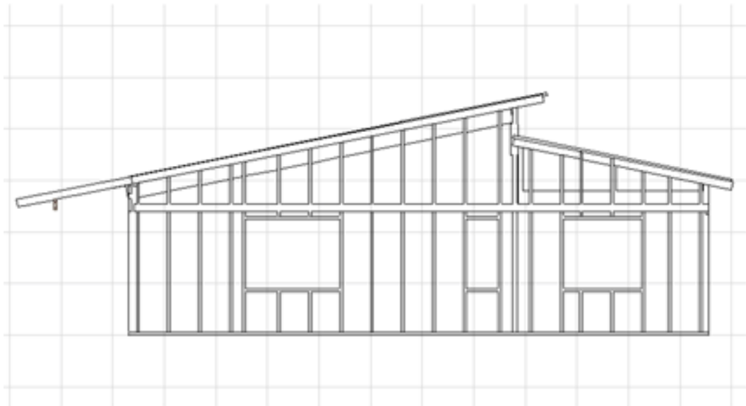
Kuva 89 Rungon ja vesikaton jäykistys /1/
