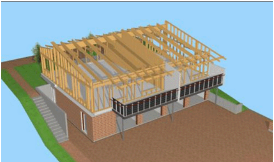
Kuva77 Pientalon puurunko: suunnitellaan ristikkokannattaja palkkirakenteen vaihtoehdoksi /1/
