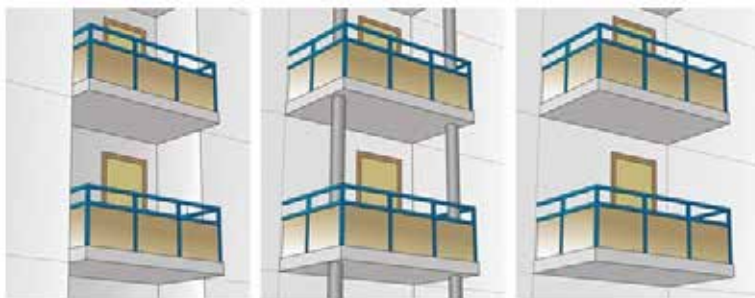
1. Runkoon upotettu 2. Alhaalta kannatettu 3. Ulokeparveke Kuva 170 Parvekeratkaisuja /6/
