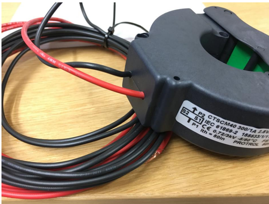
Figur 4. Strömtransformator med öppningsbart hölje för mätning av ström i en fas.
