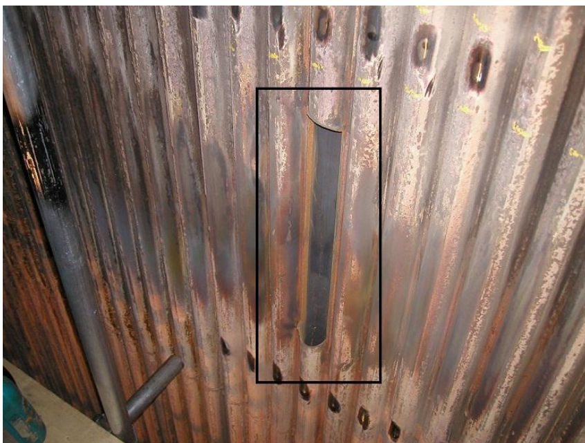
Kuva 11. Höyrystinputki repesi auki joulukuussa 2002.
