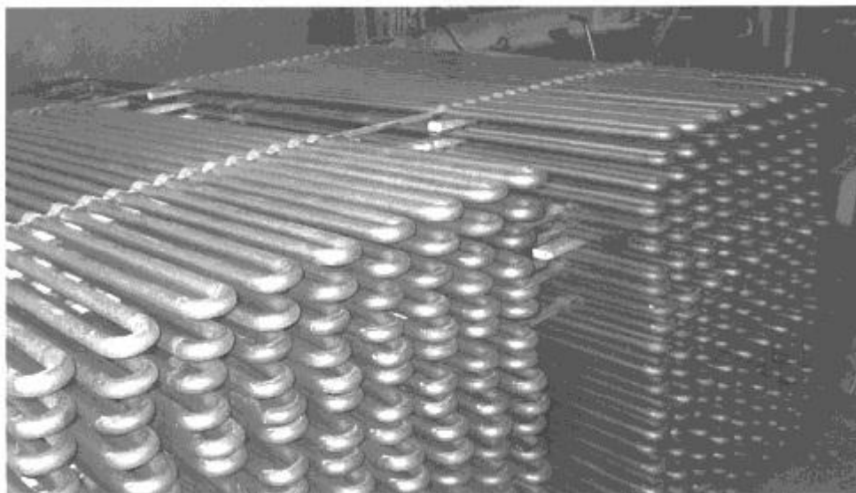
Kuva 4. Syöttöveden esilämmitysputkia kuvattuna konepajassa. /5/
