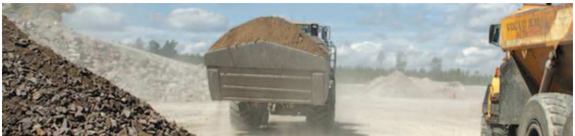
Kuva 11. Myyntikuormaukseen käytetään pyöräkuormaajaa. [18.]
