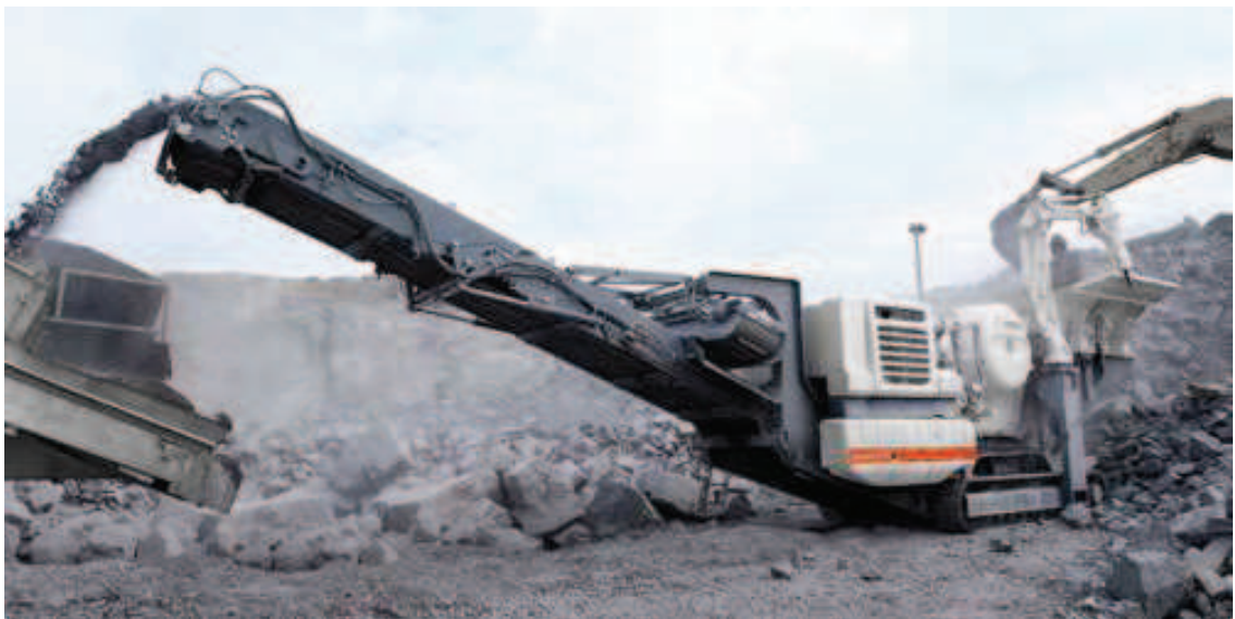
Kuva 8. Tela-alustainen leukamurskain sopii murskaustyömaille, jossa syöttö tapahtuu kaivinkoneella ja syötettävä louhe on laajalla alueella.[14.]
