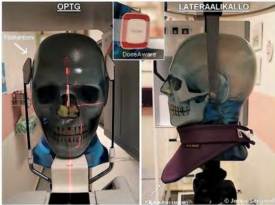
Kuvs 1. Opetuksessa käytettävä pääfantom, jolle on aseteltu kilpirauhassuoja. Dose-Aware-dosimetri mittaamassa sirontaa (kuva: Jenna Sergejeff)
