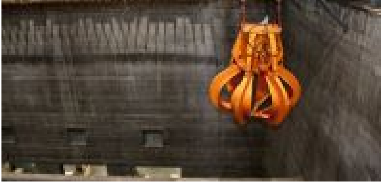
Kuva 3. Jätteiden nostamiseen käytettävä kahmarikauha. (3.)
