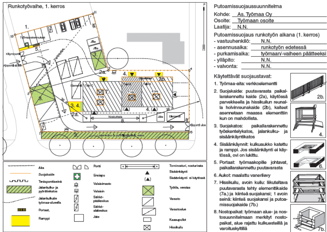
Kuva 8. Runkotyövaiheen putoamissuojaussuunnitelma (Ratu 1223-S, 15).
